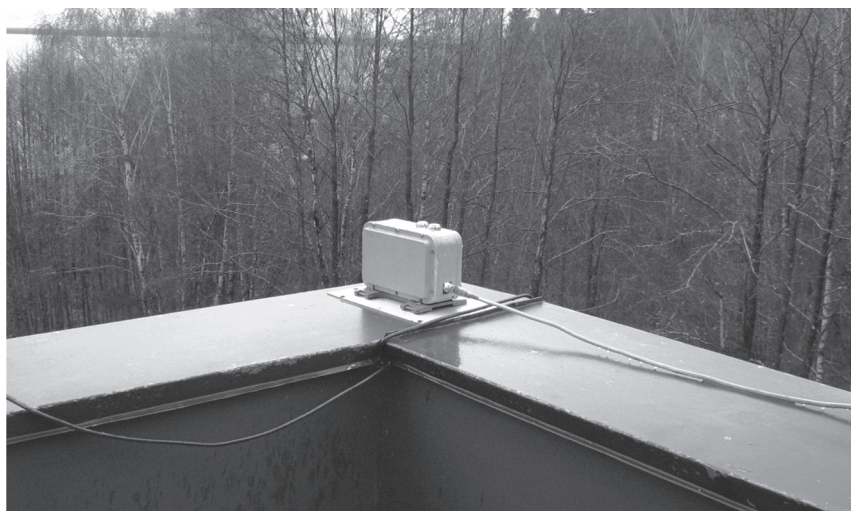
Рис. 8. Внешний вид сетевого двухканального широкополосного УФ фотометра, установленного на смотровой площадке УНЦ «Нарочанская биологическая станция имени Г. Г. Винберга»
