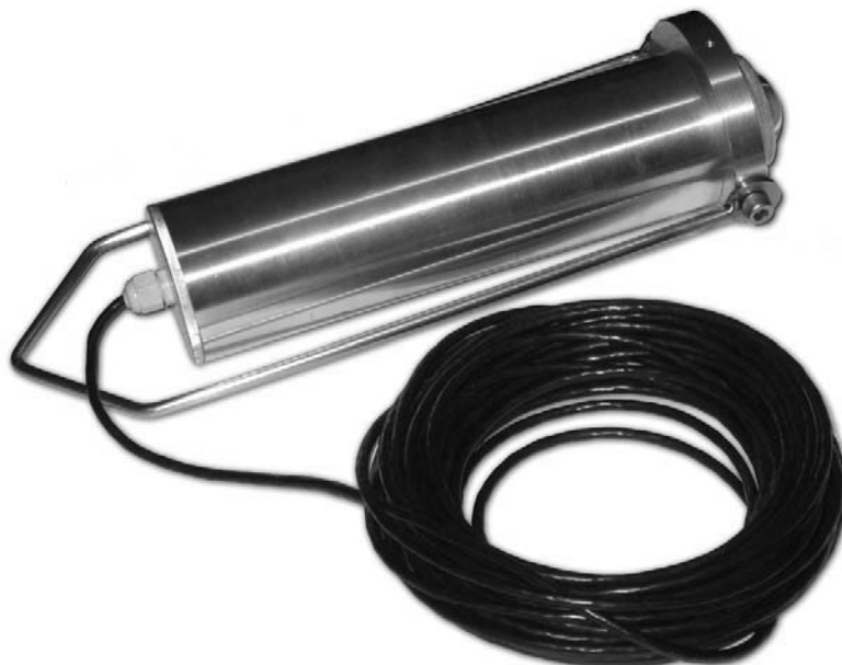
Рис. 18. Внешний вид погружного прибора для измерения распределения УФ-излучения в водной среде (ННИЦ МО БГУ, 2012 г.)
