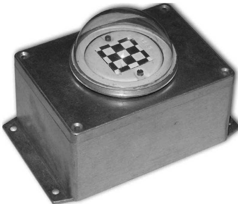
Рис. 15. Новый модернизированный вариант пиранометра (ННИЦ МО БГУ, 2011 г.)
