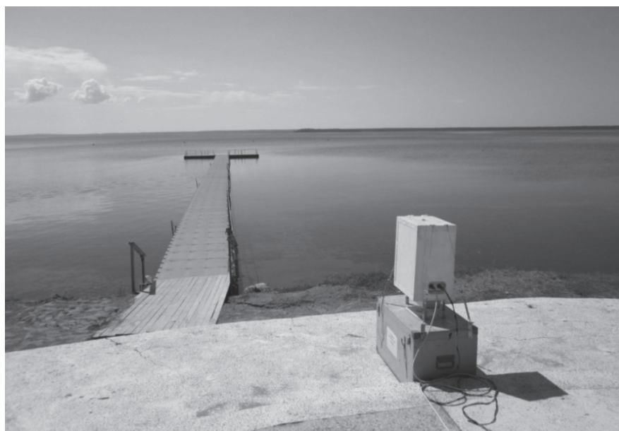
Рис. 27. Проведение измерений спектрального состава естественного приземного излучения на оз. Нарочь с помощью спектро радиометра ПИОН-УФ-П. Данные ПИОН-УФ-П использовались для калибровки погружного УФ-фотометра и проведения ретроанализа доз УФ-облученности в Нарочанском регионе
