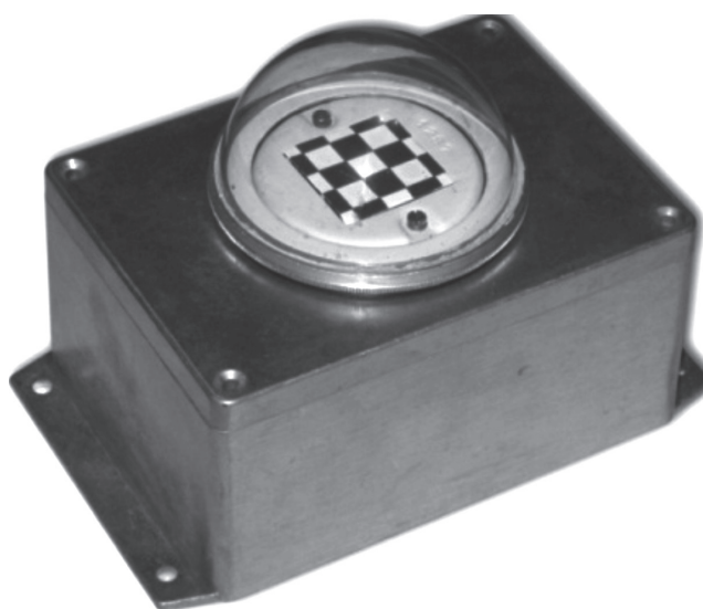
Рис. 20. Внешний вид пиранометра, используемого в качестве дополнительного канала фотометра PionPAR
