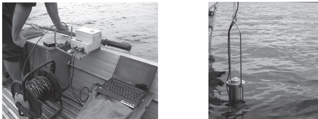
Рис. 22. Измерения интенсивности УФ-радиации на поверхности воды (надводный модуль слева) и на разных глубинах (погружной модуль справа) на оз. Нарочь
